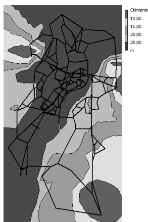
Rys. 7. Rozkład wysokości ciśnienia w PsDyW Rzeszowa podczas awarii magistrali „3” przed zbiornikiem Pobitno
