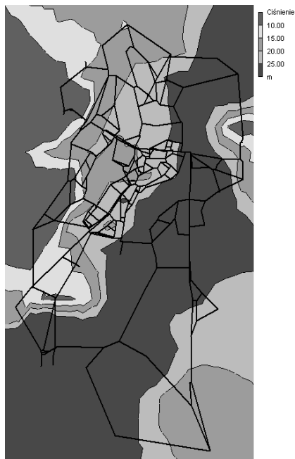
Rys. 10. Rozkład wysokości ciśnienia w PsDyW Rzeszowa (awaria magistrali „0”)
