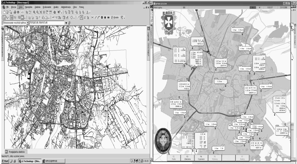
Rys. 1. Przykład mapy numerycznej sieci wodociągowej (rysunek lewy) i systemu monitoringu zainstalowanego na sieci (źródła: Robert Bryłka, Intergraph Polska, i Andrzej Żyła, MPWiK Rzeszów [13]).
