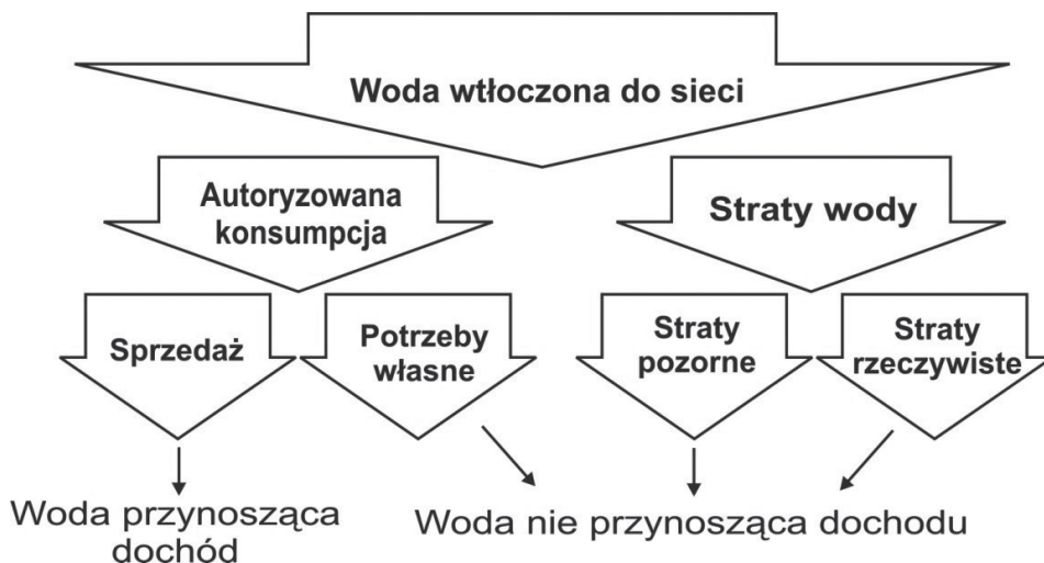
Rys. 3. Bilans wody w systemie dystrybucji (sieci wodociągowej) [1]
