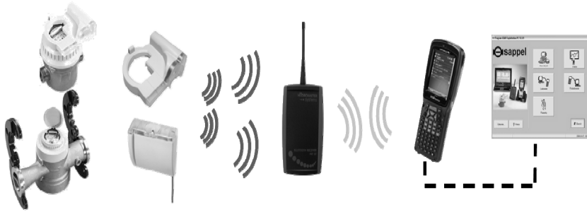
Rys.2. Struktura systemu odczytów radiowych
