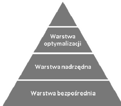
Rys. 1. Warstwy wielopoziomowego systemu sterowania
