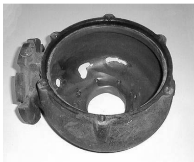
Fot. 3. Wirnik pompy zatapialnej po kilku latach pracy w środowisku z dużą zawartością piasku.
